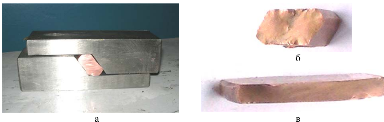
Рис. 5. Инструмент для деформирования заготовки методом реверсивного сдвига (а) и заготовки после деформирования (б) и прокатки (в)
